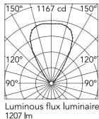
Beam Angle: 64° h(m) E(Ix) D(m) 1167 1.25 1 2.49 2 292 3.74 3 130 73 4.98 4 5 6.23 47
