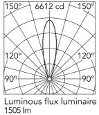
Beam Angle: 25° h(m) E(lx) D(m) 6612 0.45 1 0.90 2 1653 1.35 3 735 1.80 4 413 5 2.25 264
