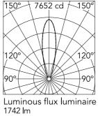
Beam Angle: 25° h(m) E(lx) D(m) 7652 0.45 1 1913 0.90 2 1.35 3 850 478 1.80 4 5 306 2.25
