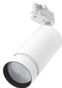
Scheinwerfer mit LED Lichtquelle zum Einbau in Standard-Dreiphasenschiene. Besitzt eine verstellbare Linse, mit der man den Öffnungswinkel von 13° bis 56° verändern kann. Netzgerät 120-270V inbegriffen. Bei den „All White“ -Versionen sind der Schienenadapter, der Arm, der Hinterkopf und der Kopf weiß, nur der Blendschutzring bleibt schwarz.
