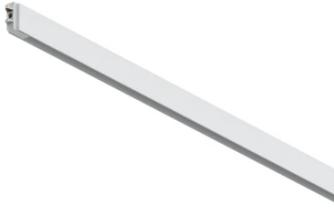
Elektromechanisches Innenprofil mit integrierter direkter und indirekter linearer Beleuchtung für die Oberflächen- oder Aufhängeinstallation. Mit Längen von 1 bis 2,5 m (Abstand zwischen den Kugelgelenkzentren). Mit Befestigung durch Aufhängungset angetrieben und durch Kugelgelenk aufgehängt. Es ist erforderlich, ein separates Aufhängungset und ein mechanisches Kugelgelenk zu bestellen. System wird durch 1-10V, DALI oder Casambi kontrolliert....
