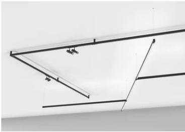
Elektromechanisches Innenprofil mit integrierter direkter und indirekter linearer Beleuchtung für die Oberflächen- oder Aufhängeinstallation. Mit Längen von 1 bis 2,5 m (Abstand zwischen den Kugelgelenkzentren). Mit Befestigung durch Aufhängungset angetrieben und durch Kugelgelenk aufgehängt. Es ist erforderlich, ein separates Aufhängungset und ein mechanisches Kugelgelenk zu bestellen. System wird durch 1-10V, DALI oder Casambi kontrolliert. Broadcast-Steuerungssystem. Dimmer nicht enthalten.
