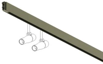
Elektromechanisches Innenprofil mit integrierter direkter linearer Beleuchtung und Platz für zwei Spots für Aufputz- oder Aufhängeinstallation. Mit Mit Längen von 1 bis 2,5 m (Abstand zwischen den Kugelgelenkzentren). Mit Befestigung durch Aufhängungssatz angetrieben und durch Kugelgelenk aufgehängt. Es ist erforderlich, ein separates Aufhängungsset und ein mechanisches Kugelgelenk zu bestellen. System wird durch 1-10V, DALI oder...
