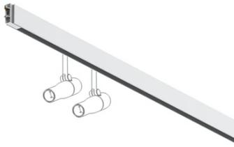
Elektromechanisches Innenprofil mit integrierter direkter linearer Beleuchtung und Platz für zwei Spots für Aufputz- oder Aufhängeinstallation. Mit Längen von 1 bis 2,5 m (Abstand zwischen den Kugelgelenkzentren). Mit Befestigung durch Aufhängungsset angetrieben und durch Kugelgelenk aufgehängt. Es ist erforderlich, ein separates Aufhängungsset und ein mechanisches Kugelgelenk zu bestellen. System wird durch 1-10V, DALI oder...
