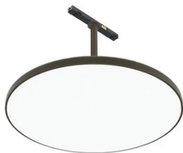
LED-Akzentbeleuchtungsmodul zum Einbau in das Zero Track-System. Integrierter elektronischer Leistungswandler DC/DC. Modul geregelt durch Casambi-Treiber, 1-10V-, oder DALI im Broadcast-Modus. Für die individuelle Steuerung der Leuchten sind die integrierten Casambi-Versionen auszuwählen. Kann nicht in senkrechten Schienen installiert werden.
