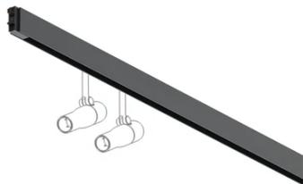
Profilo elettromeccanico da interni con illuminazione lineare diretta integrata e spazio per due spot, per installazione a superficie o in sospensione. Con lunghezze da 1 a 2,5m (distanza tra i centri dei giunti sferici). Da fissare con kit di sospensione alimentato e sostenuto mediante giunto. Kit di alimentazione e giunto meccanico da ordinare separatamente. Sistema...
