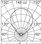
Luminous flux luminaire 269 lm
