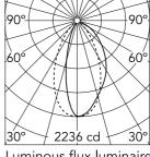
Luminous flux luminaire 2204 lm
