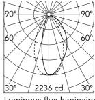
Beam Angle: h(m) = E(Ix)D(m) 0.98 2236 1.97 2 559 3 248 2.95 140 3.94 4 5 4.92 89
