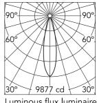
Luminous flux luminaire 2176 lm
