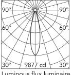
Luminous flux luminaire 2176 lm
