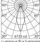
Luminous flux luminaire 2408 lm
