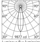
Luminous flux luminaire 2176 lm
