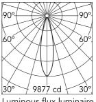
Luminous flux luminaire 2176 lm
