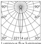
Luminous flux luminaire 3248 lm
