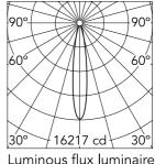
Luminous flux luminaire 2216 lm
