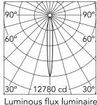
Luminous flux luminaire 1094 lm
