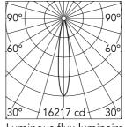
Luminous flux luminaire 2216 lm
