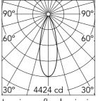
Luminous flux luminaire 1496 lm
