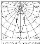
Luminous flux luminaire 2074 lm
