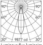
Luminous flux luminaire 2176 lm
