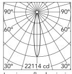
Luminous flux luminaire 3248 lm
