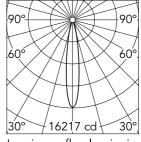
Luminous flux luminaire 2216 lm
