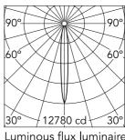
Luminous flux luminaire 1094 lm
