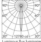
Luminous flux luminaire 1094 lm
