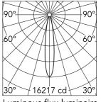
Luminous flux luminaire 2216 lm
