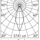
Luminous flux luminaire 2053 lm
