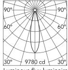
Luminous flux luminaire 2155 lm
