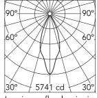
Luminous flux luminaire 2053 lm
