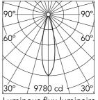
Luminous flux luminaire 2155 lm
