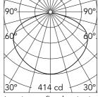
Luminous flux luminaire 1474 lm
