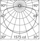
Luminous flux luminaire 21700 lm
