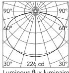
Luminous flux luminaire 3165 lm
