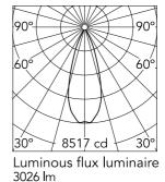
Beam Angle: 35° h(m) E(lx) D(m) 8517 0.64 2129 1.28 3 946 1.92 4 532 2.55 341 3.19
