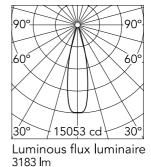
Beam Angle: 25° h(m) E(lx) D(m) 15053 0.45 3763 0.90 3 1673 1.34 1.79 4 941 602 2.24
