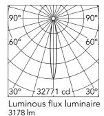
Beam Angle: 12° h(m) E(lx) D(m) 32771 0.22 8193 0.43 3 3641 0.65 4 2048 0.87 1311 1.08
