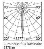
Beam Angle: 12° h(m) = E(Ix)D(m) 32771 0.22 8193 0.43 3 3641 0.65 2048 0.87 5 1311 1.08
