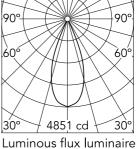
Beam Angle: E(Ix)D(m) h(m) 4851 0.73 1213 1.46 3 539 2.18 4 303 2.91 5 194 3.64
