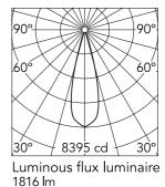
Beam Angle: 28°  $E(I_X)$ D(m) h(m) 8395 0.50 2099 1.00 3 933 1.50 4 525 2.00 336 2.50
