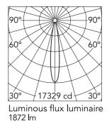
Beam Angle: 16° h(m) = E(lx)D(m) 17329 0.28 4332 0.56 3 1925 0.84 4 1083 1.12 693 1.40
