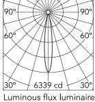
Beam Angle: 15° h(m) E(lx) D(m) 6339 0.26 1585 0.52 3 704 0.77 4 396 1.03 254 1.29
