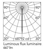
4° Beam Angle: h(m) E(lx) D(m) 68792 0.07 17198 0.14 3 7644 0.21 4 4300 0.28 2752 0.35
