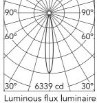
Beam Angle: 15° h(m) = E(Ix)D(m) 6339 0.26 2 1585 0.52 3 704 0.77 4 396 1.03 5 254 1.29
