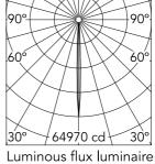
4° Beam Angle: h(m) = E(Ix)D(m) 64970 0.07 16243 0.14 3 7219 0.21 4061 0.28 5 2599 0.35
