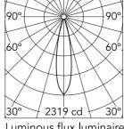
Luminous flux luminaire 392 lm
