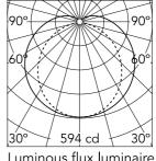
Luminous flux luminaire 2423 lm
